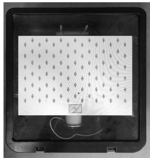
Figura 4: cable conectado y lente cerrada
