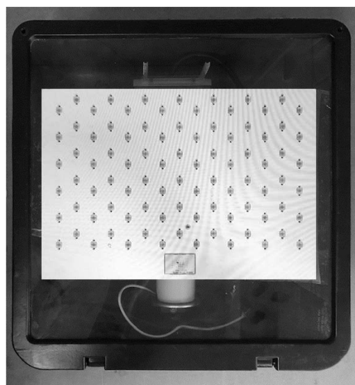
Figure 4 - Câble connecté et objectif fermé
